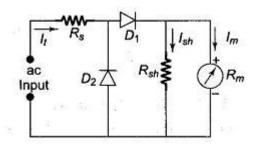
Fig. 4.17 General Rectifier Type ac Voltmeter
