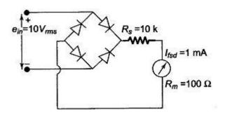
Fig. 4.20 ac Voltmeter Using Full Wave Rectifier
