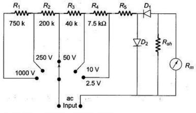
Fig. 4.22 Multirange ac Voltmeter
