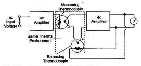
Fig. 4.25 True RMS Voltmeter (Block Diagram)
