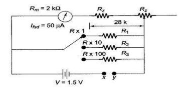
Fig. 4.29 Multirange Ohmmeter
