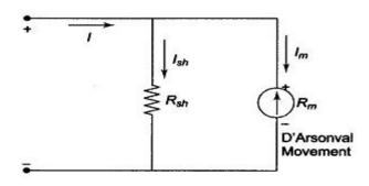
Fig. 3.1 Basic dc Ammeter
